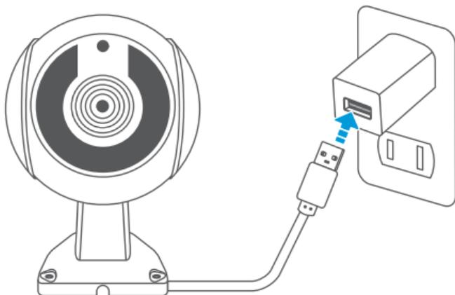
*Al conectar la cámara, emitirá “beeps” continuamente, indicando que está en espera de conexión Wi-Fi.*
